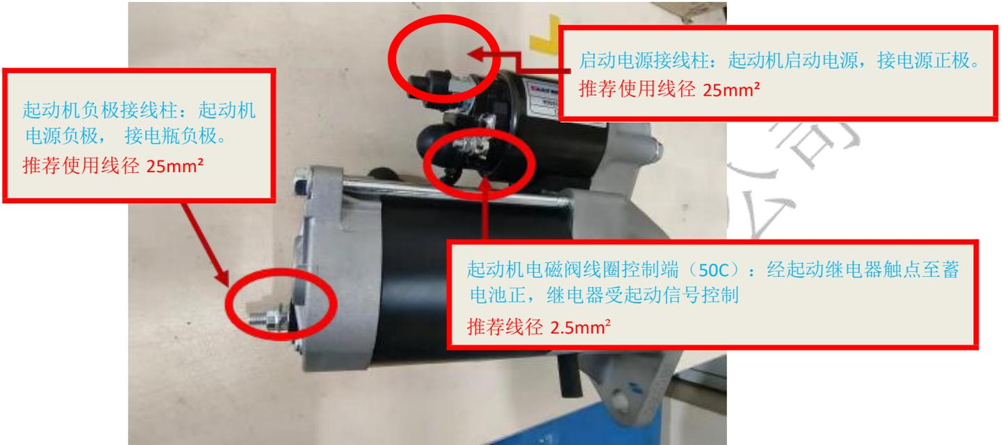
起动机负极接线柱：起动机
