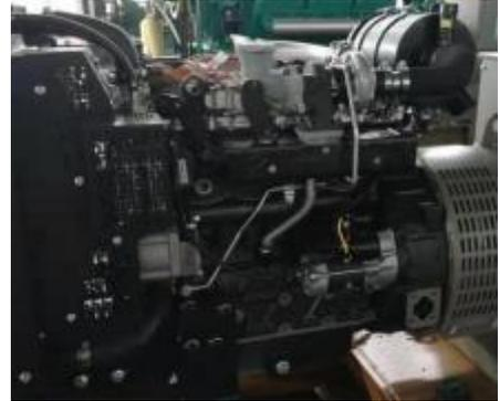
**建议：**蓄电池正极主线连接起动机正极 B+，受总开关控制的负极直接连接飞轮壳螺栓处，要求连接牢固可靠。关于主线线径选择可参考如下表格，表格中线径仅为计算数值用以参考，请根据实际情况选择合适的线径。
