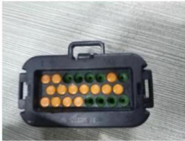
如图所示，该护套是对接我司使用的船用监控仪。如你不使用我司提供的监控仪，你可以将 4 根信号线（上电、CANH、CANL、起动）单独挑出，接仪表即可。电源线为我司仪表用电源，可不使用。
