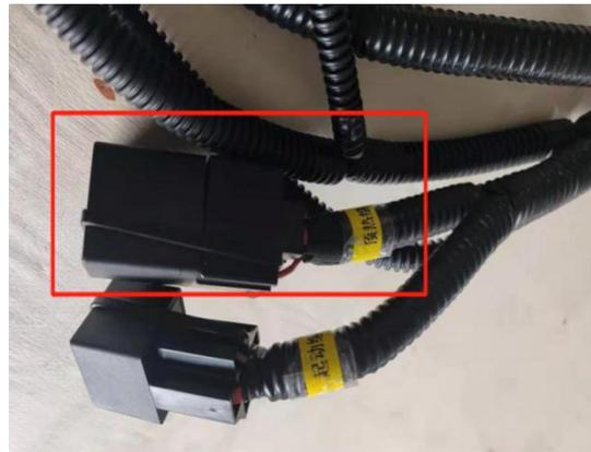
注：预热塞工作时间是受发动机 ECU 控制，第一：接线过程中确认预热塞插头是接插否正确；第二：预热继电器是否工作正常。
