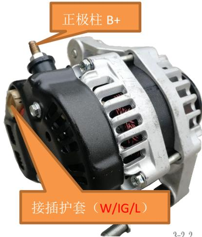
发电机采用常规日式结构
